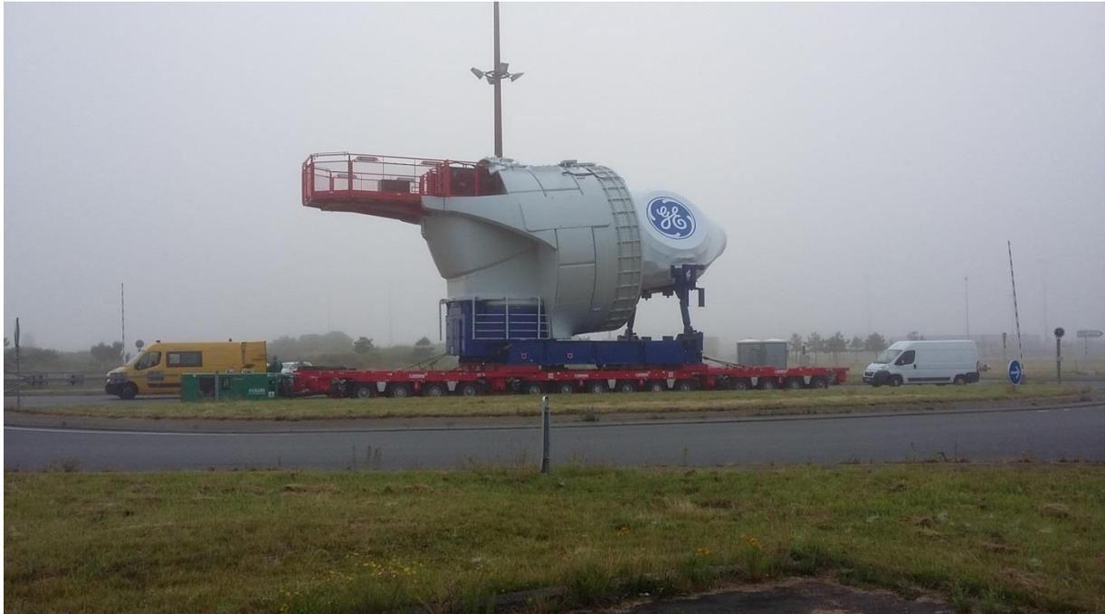
*Exemple d'un multiwheeler transportant une nacelle d'éolienne off-shore*
